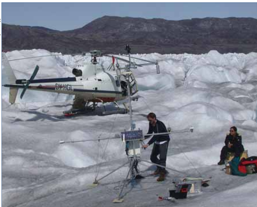
De fuldautomatiske målestationer er udviklet, så de kan klemmes ind i de små helikoptere, der bruges under opsætningen på Indlandsisen
